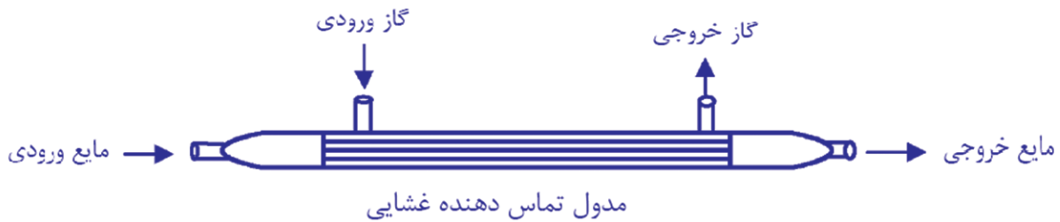
شکل ۲: مدول جریان موازی الیاف توخالی تماس دهنده غشایی گاز-مایع [۳۱]
