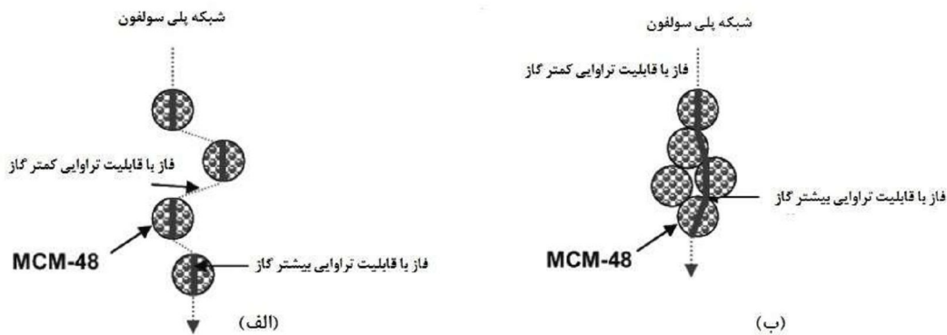
شکل ۵. تأثیر محتوای افزودنی ذرات MCM-48 بر گذرگاه‌های غشای پلی سولفون: الف) تشکیل گذرگاه ناپیوسته (۱۰ درصد وزنی MCM-48) ب) تشکیل گذرگاه پیوسته (۲۰ درصد وزنی MCM-48) [۱۶]
