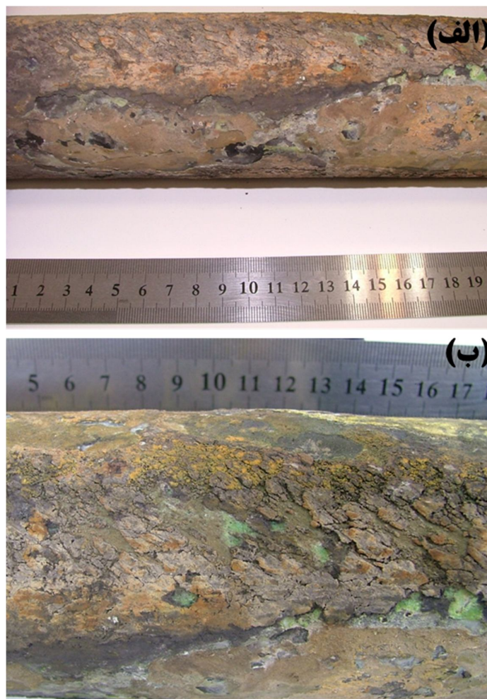
شکل 2. تصویر سطح خارجی تیوب تخریب شده.
