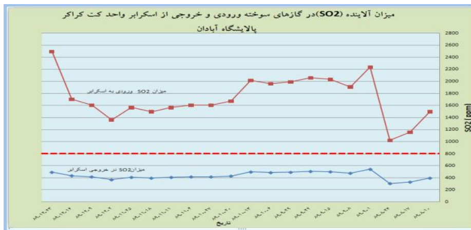
شکل ۹. میزان آلاینده (SO 2 ) در گازهای سوخته ورودی و خروجی از اسکرابر واحد کت کراکر پالایشگاه آبادان
