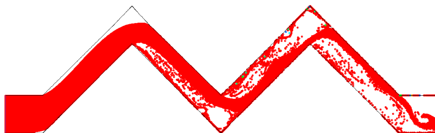
شکل ۱۱- مسیر قطرات در پره بدون کانال
