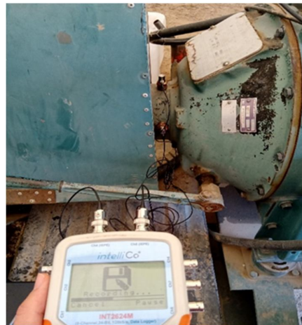
شکل 2. تجهیزات داده برداری شامل دیتالاگر و سنسورهای ارتعاش سنج.
