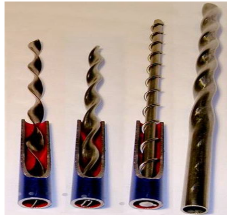
شکل 1. انواع نوارهای تابیده (از سمت راست به چپ: لوله تابیده و نوار تابیده هم‌زمان، نوارهای تابیده با میله نگه‌دارنده، نوار تابیده ساعت‌گرد، نوار تابیده پادساعت‌گرد با ضخامت کم) [1]
