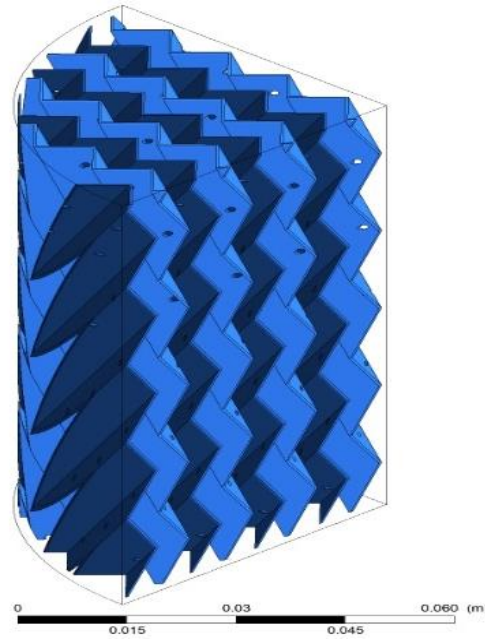
شکل ۳. هندسه آکنه SulzerBX با صفحات سوراخ‌دار
