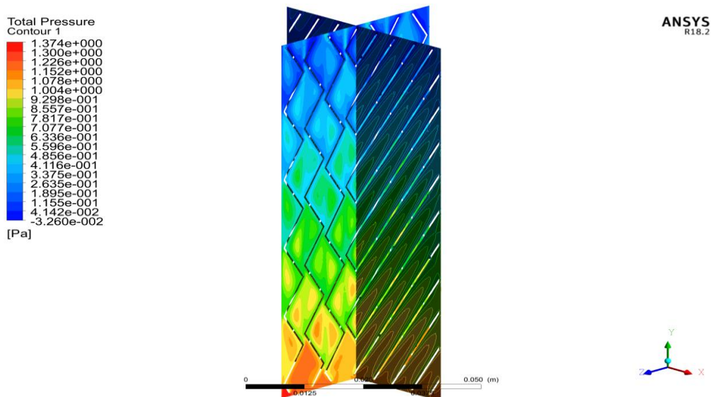
شکل ۶. کانتور فشار در آکنه سوراخ‌دار
