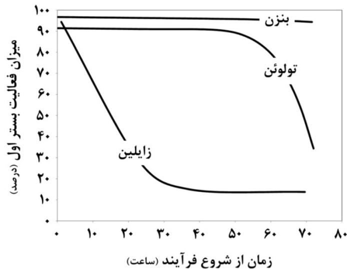
شکل ۱۰. میزان غیرفعال شدن کاتالیست بستر اول در حضور ترکیبات BTX در آزمایشات آرامکو [۱۲]
