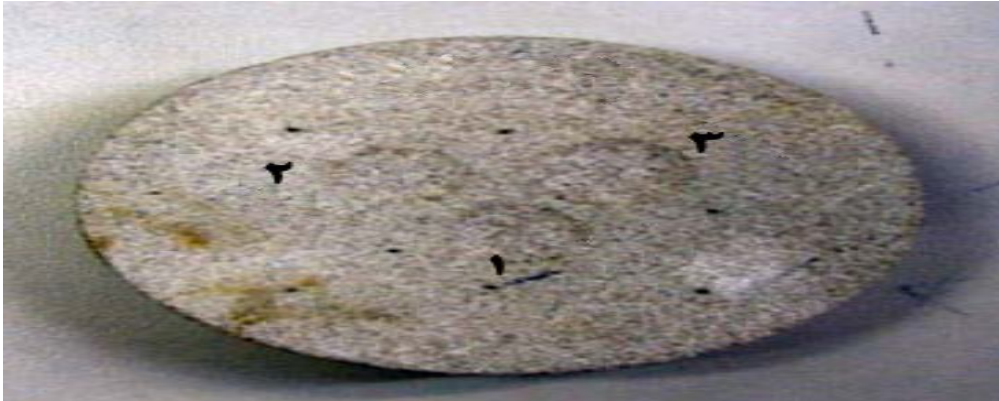
شکل ۳. نقاط سطحی حفاری شده بوسیله سه نوع پارامتر لیزری متفاوت: E8L1R50 (نقطه ۱)، E8L2R50 (نقطه ۲) و E8L3R100 (نقطه ۳)
