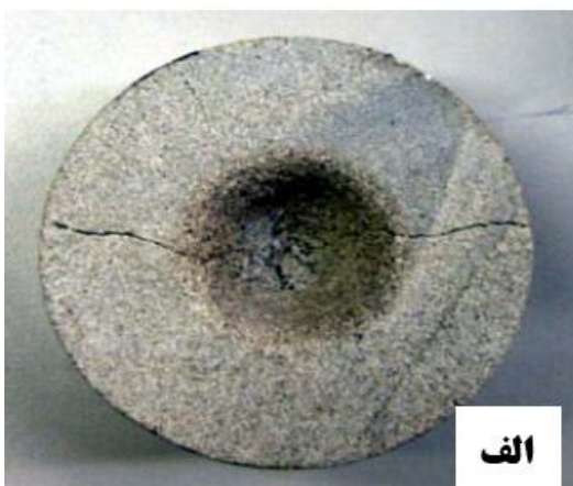
شکل ۴. سوراخ‌های ایجاد شده در نمونه سنگ‌های مخزن بوسیله لیزر (الف) ترک خورده و (ب) ترک نخورده
