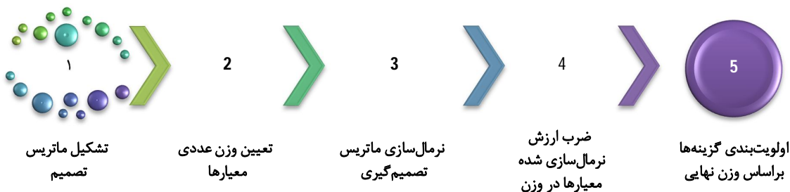
شکل ۳. نمایش مراحل اولویت‌بندی گزینه‌ها به کمک روش مجموع وزنی ساده
