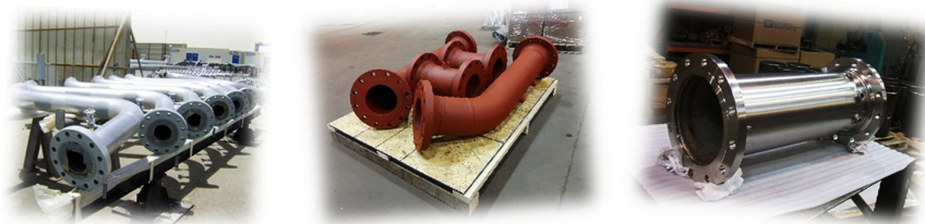
شکل ۱. اسپول‌های پیش‌ساخته شده در کارگاه صنعتی
