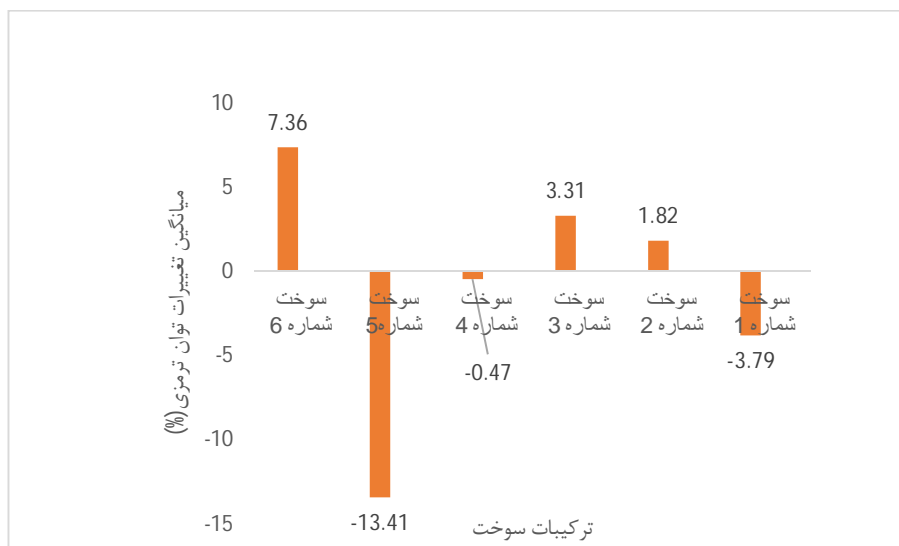
شکل 4- درصد تغییرات توان موتور با استفاده از مخلوط‌های سوخت نسبت به بنزین خالص
