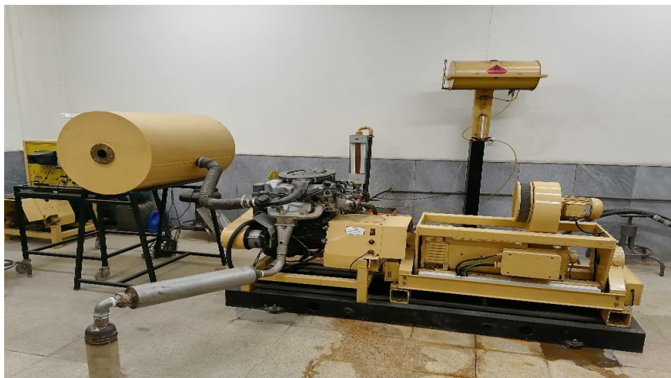
شکل 1- موتور کوپله شده به دینانومتر
