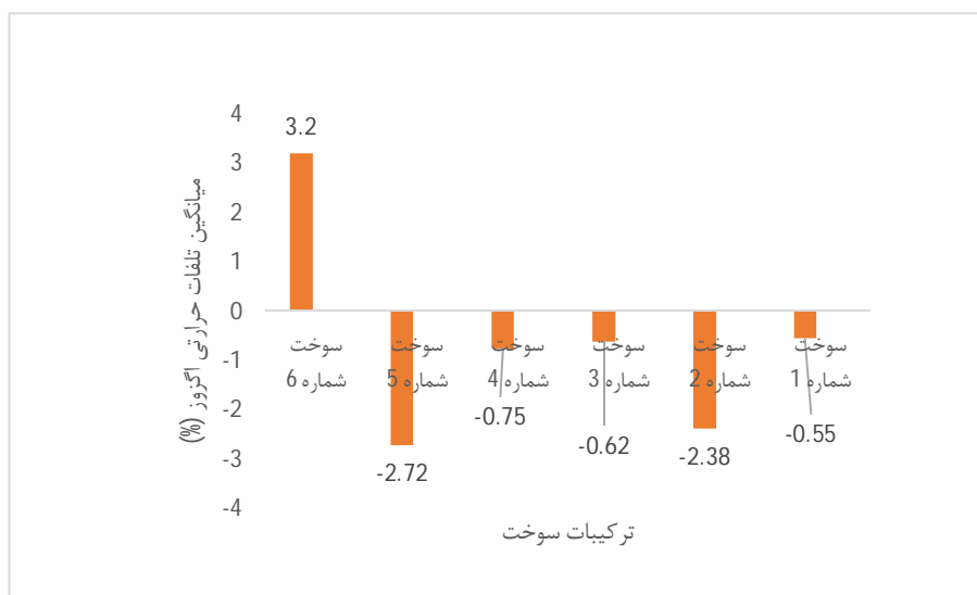
شکل 8- درصد تغییرات تلفات حرارتی اگزوز موتور با استفاده از مخلوط‌های سوخت نسبت به بنزین خالص.
