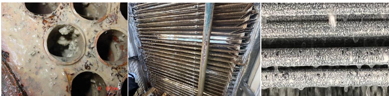
شکل ۱- خوردگی لوله‌ها و مبدل‌های آلومینیومی در سیستم‌های خنک‌کننده هلو
