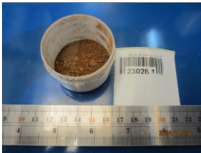
شکل ۵- نمونه رسوب زیرکش کندانسور برج خنک‌کننده خشک
