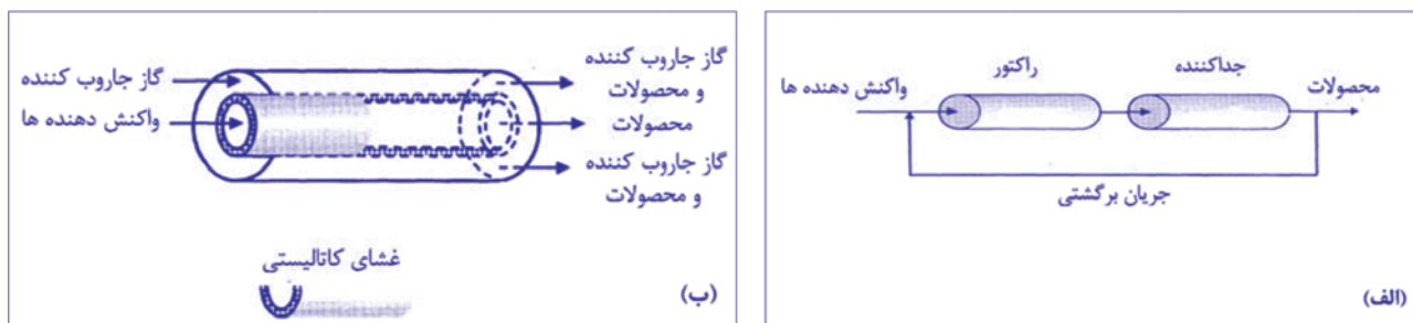
شکل ۱: راکتورهای غشایی (الف) اولیه، (ب) مرسوم [۶]
