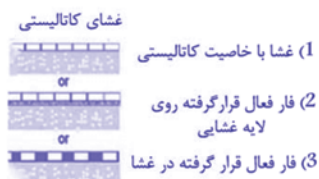
شکل ۱: راکتورهای غشایی (الف) اولیه، (ب) مرسوم [۶]
