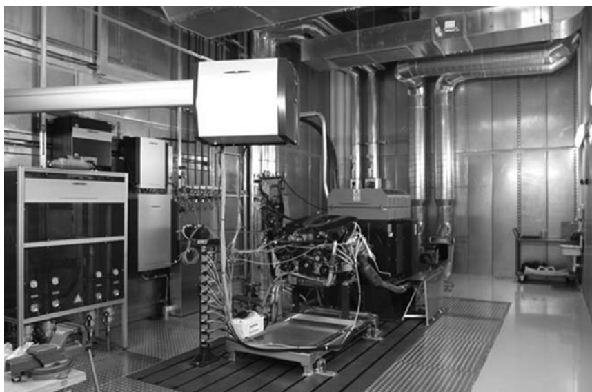
شکل ۳- نمایی از یک اتاق تست موتور (سلول تست) و تجهیزات آن [۱].
