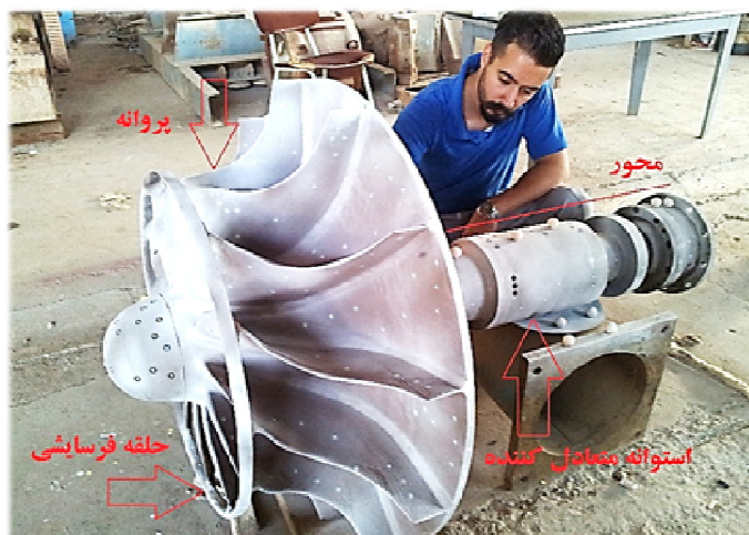
شکل ۹. نقشه برداری از روتور بلوور BL-1601 توسط کارشناسان شرکت های داخلی
