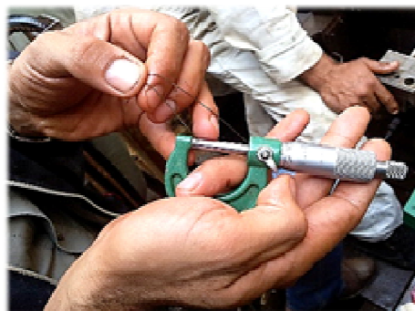
شکل ۱۳. اندازه گیری رشته سیم‌های سربی لهیده شده با میکرومتر
