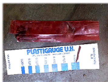
شکل ۱۴. اندازه‌گیری رشته سیم‌های پلاستیکی لهیده شده بصورت مطابقت دادن با جدول
