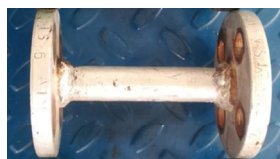
شکل ۳- قطعه استاتیک میکسر قابل تعویض، مورد استفاده در انجام تست‌ها
