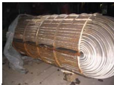
شکل 3- مبدل حرارتی ضدترسیب در صنعت پتروشیمی: (الف) قبل از نصب، (ب) پس از نصب در واحد
