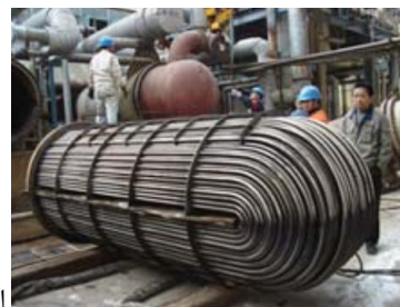
شکل 3- مبدل حرارتی ضدترسیب در صنعت پتروشیمی: (الف) قبل از نصب، (ب) پس از نصب در واحد
