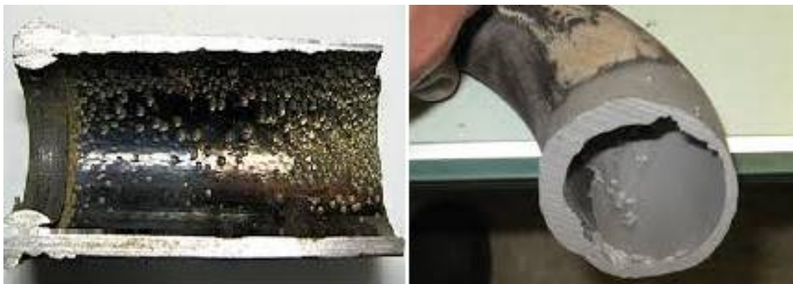
شکل 1- پدیده FAC و نازک شدن لوله [17]
