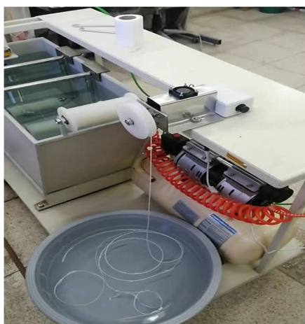
شکل 2- تصویری از فرایند ساخت غشای الیاف توخالی
