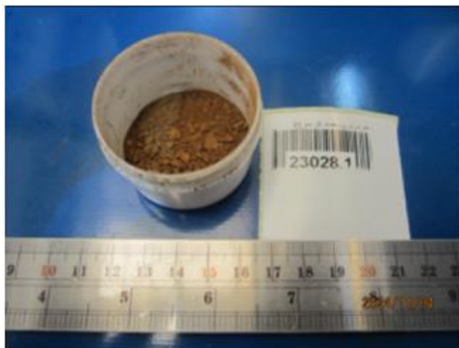
شکل ۵- نمونه رسوب زیرکش کندانسور برج خنک‌کننده خشک
